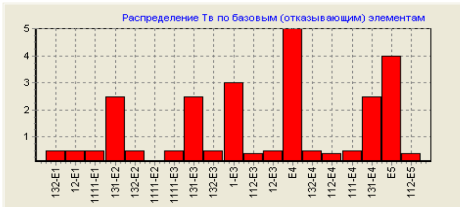
Рис. 5. Гістограма розподілу часу заміни по базових елементах у випадку, якщо час заміни елемента 132 і 12 дорівнює 0,5 год.
