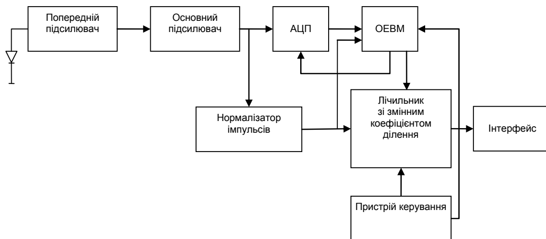
Рис. 1. Структурна схема блоку детектування на основі CdZnTe
