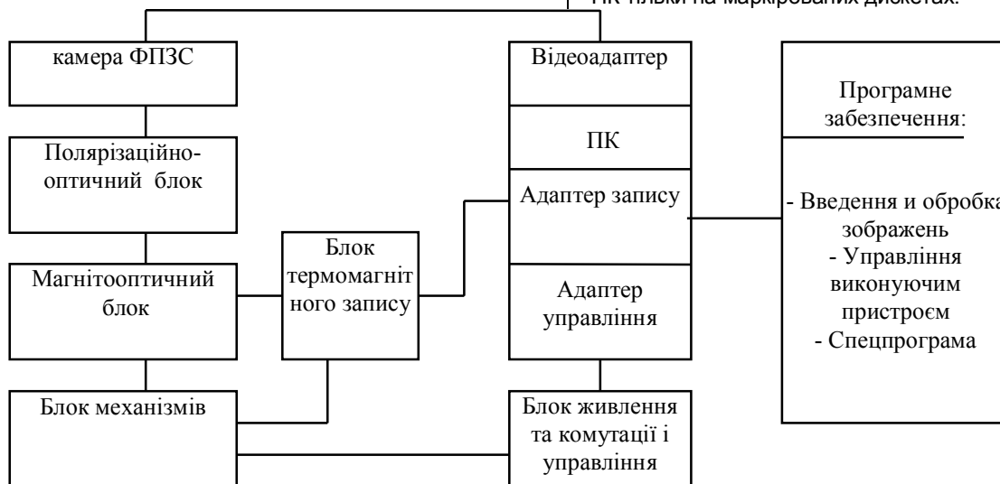
Рис. 6. Структурна схема стенду магнітооптичного кодування
