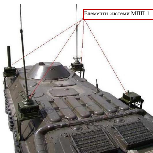
Рис. 2. Елементи системи МПП-1, встановлені на бронеоб'єктах
