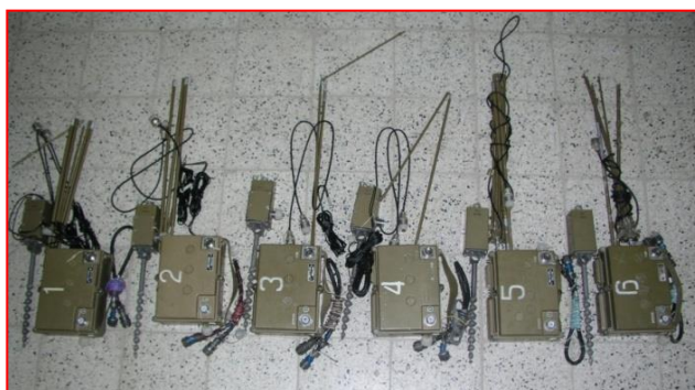
Рис. 1. Загальний вигляд малогабаритних передавачів перешкод -1
