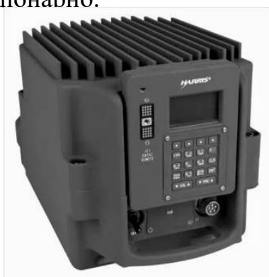
Рис. 7. Радіостанція «Harris» RF-7800V-VS511
