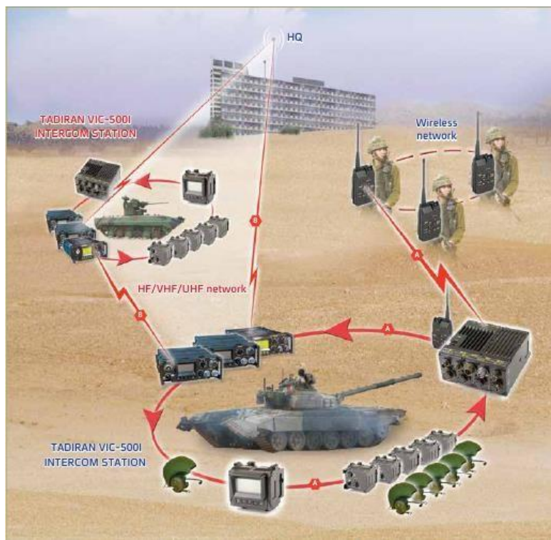
Рис. 4. Апаратура внутрішнього зв'язку та комутації VIC-500 Основні параметри та ТТХ
