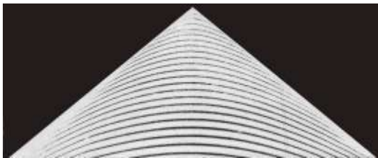
Рис. 2. Фотознімок сімейства ізоліній на поверхні конуса, отриманих проектуванням лінійного растра паралельним пучком променів коліматора
