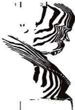
Рис. 7. Знімок скульптури з локалізованими на поверхні перерізами, отриманими проектуванням пучка площин: 1 - площина нульового перерізу, 2 –
